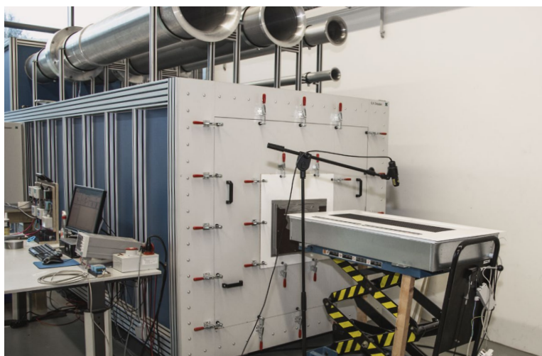
Banc d'essai pour la mesure des puissances de débit d'air ; KAMPMANN F&E Center
